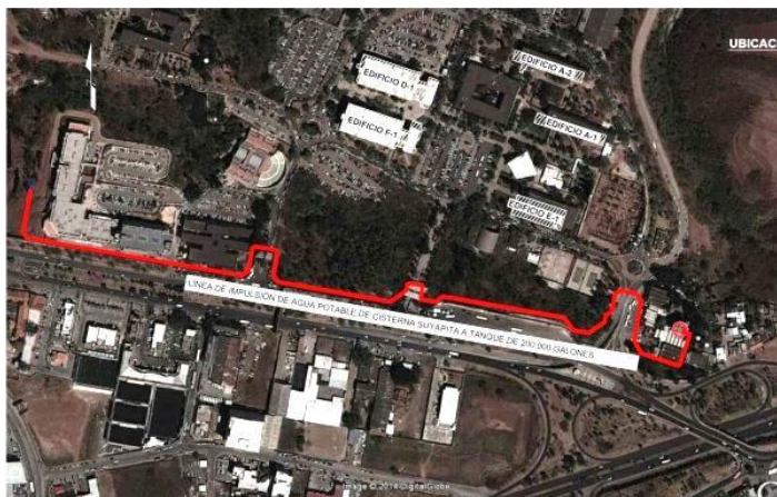
Conjunto de línea de impulsión de cisterna "Suyapita" a Tanque elevado de 200,000 galones
