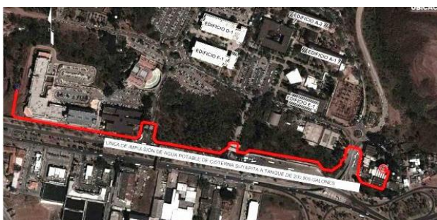
Conjunto de línea de impulsión de cisterna “Suypita” a Tanque elevado de 200,000 galones
